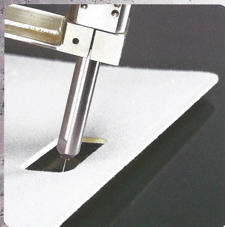
自動車内装材のトリミング加工 Trimming of Automotive Interior Materials
